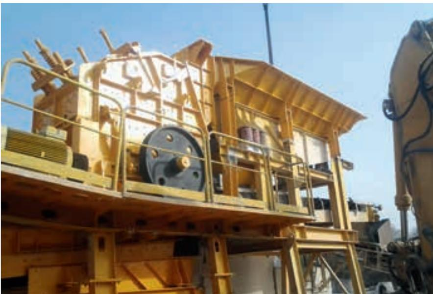
**AUSTAUSCHHEINHEIT:** Die Prallmühle PT130/130 ersetzt als Brecherstation mit Aufgabe einen weniger zuverlässigen Vorgänger.
