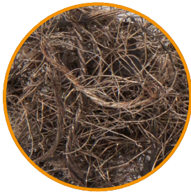
Reifendrähte nach dem Vorshredder mit hohem Gummianteil
