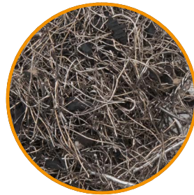
Reifendrähte nach PTV, Delamination von Draht und Gummi in einem Durchgang um 99%
